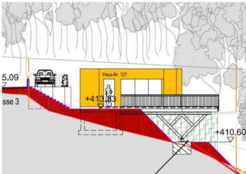
Abbildung 20: Systemschnitt steileres Gelände: Erfordernis von Aufständering und Stützkonstruktion
