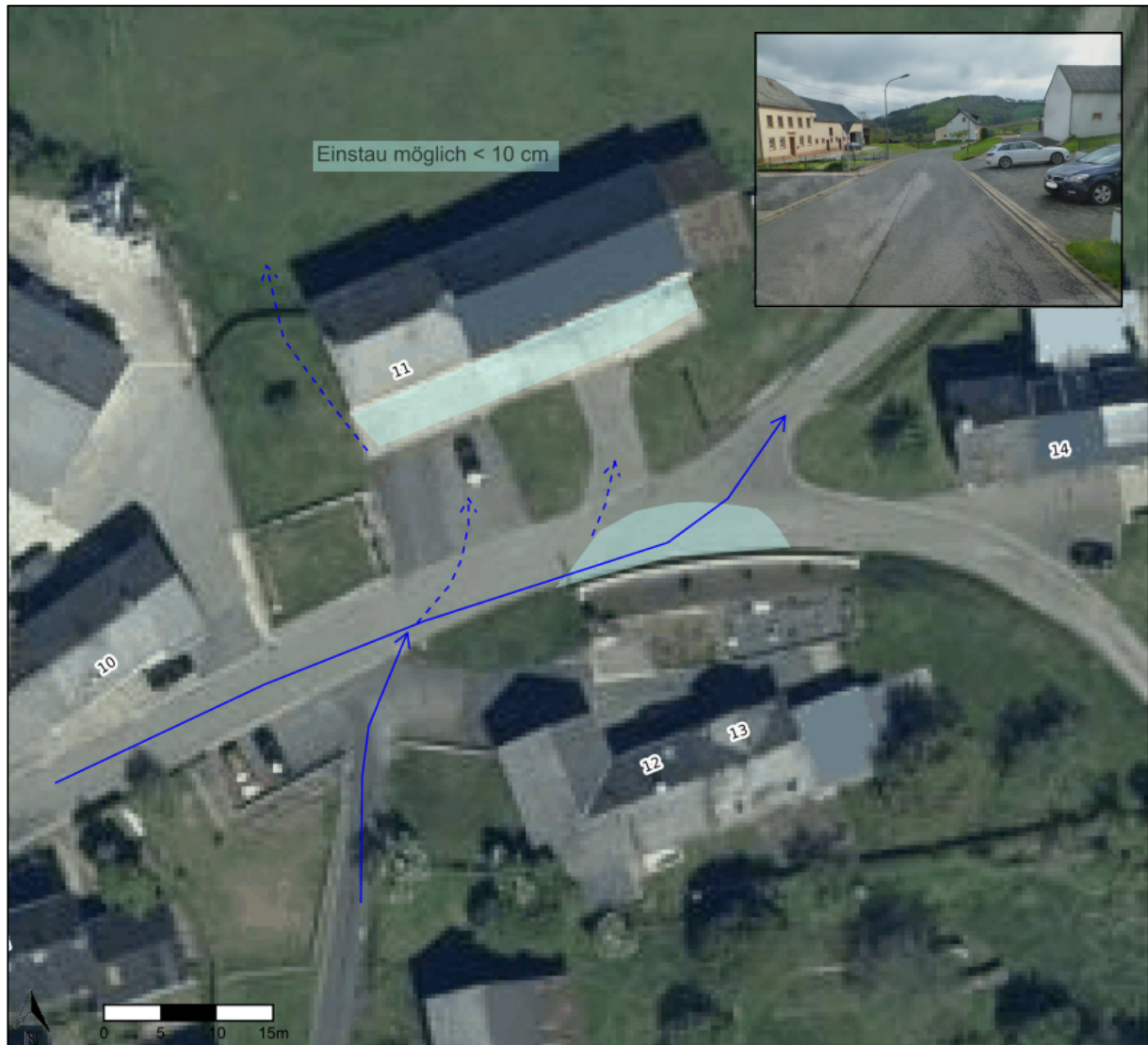
Abbildung 34: Bereiche mit Einstau und Abflusswege
