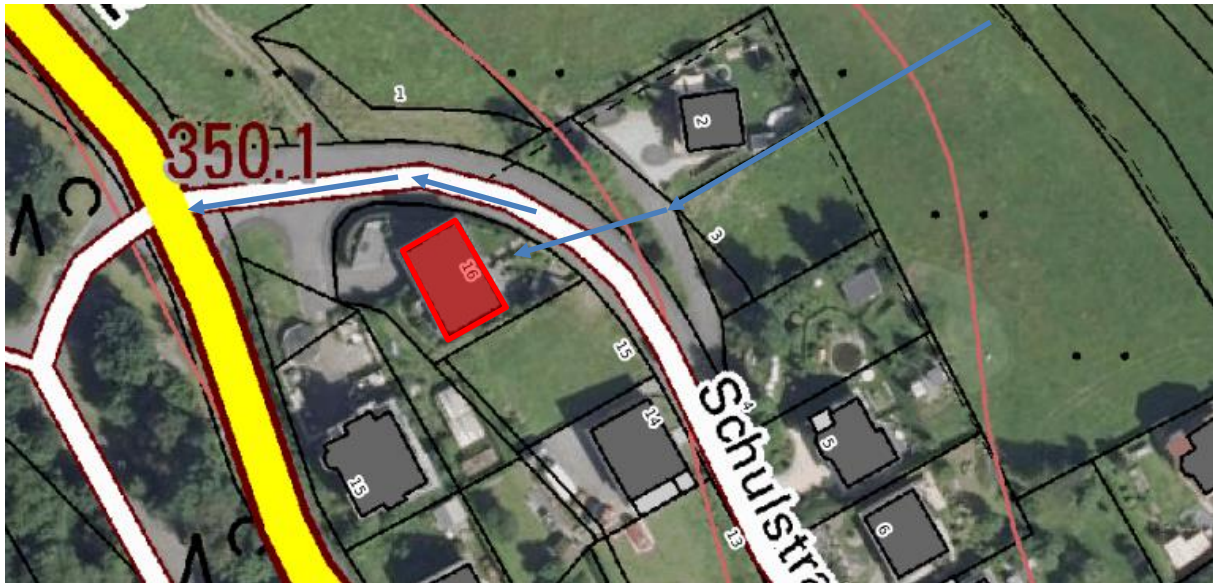
Abbildung 82: besonders gefährdetes Objekt (rot markiert) und Fließweg (blaue Pfeile) der Tiefenlinie „Staudigt“
